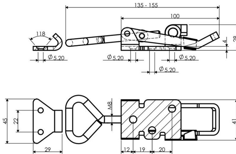
**M40S Waagrechtspanner mit Sicherheitsverriegelung**
