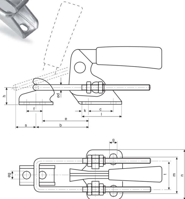
M40D Verschlussspanner/Bügelspanner vertikal
