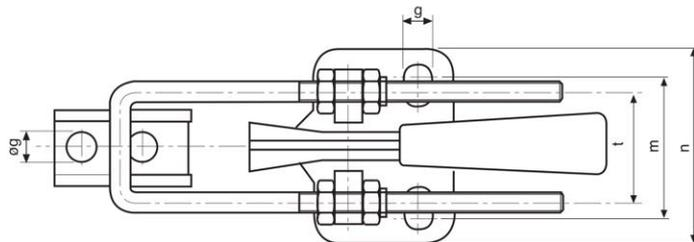
**M46S Hakenspanner mit Sicherheitsverriegelung**
